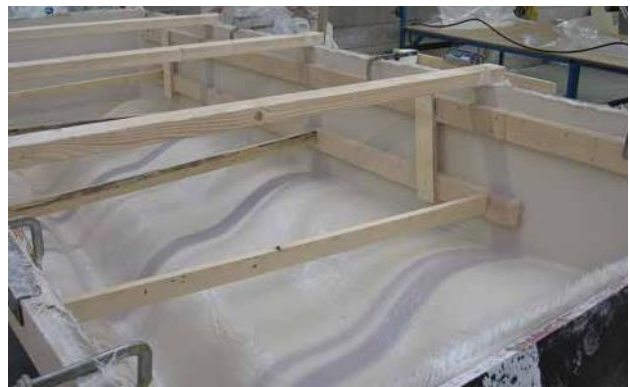
层压元件, 侧面放置36毫米胶合板横梁
