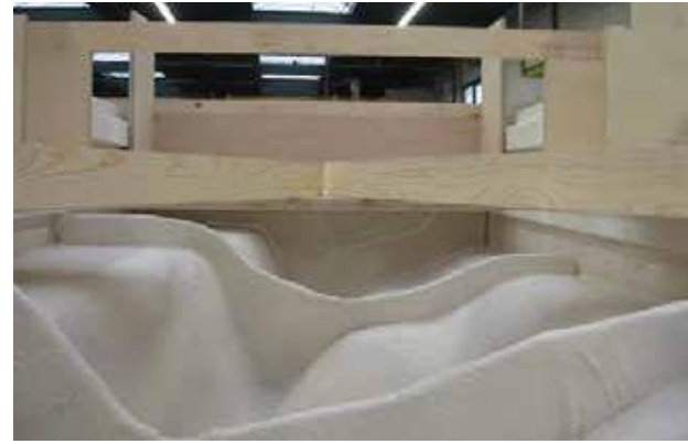
层压板和18 mm胶合板条的进一步内部加固
